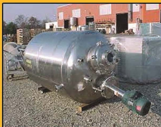
راکتور شیمیائی گاز جامد ( تحت استاندارد ASME Sec8. Div1 )
