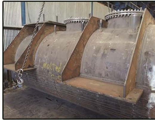
مخزن نمک شیمیائی مذاب ( تحت استاندارد ASME Sec8. Div2 )
