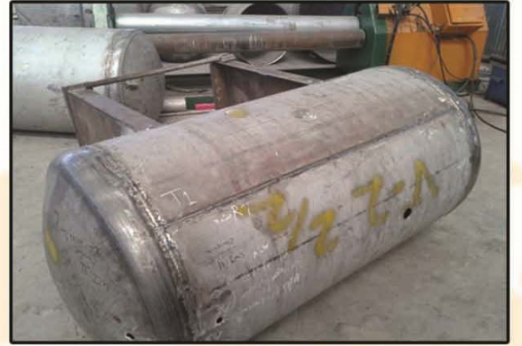
مخزن تحت فشار ( تحت استاندارد ASME Sec8 )
